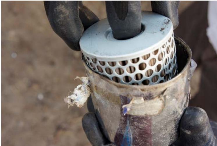
Fotografía No. 15 Filtro de combustible principal
