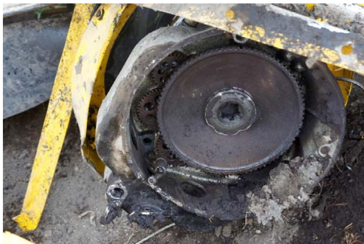
Fotografía No. 14 Caja de accesorios separada del motor.
