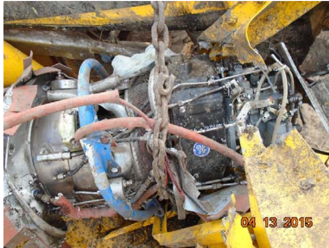
Fotografía No. 11 El motor quedó inservible en el impacto
